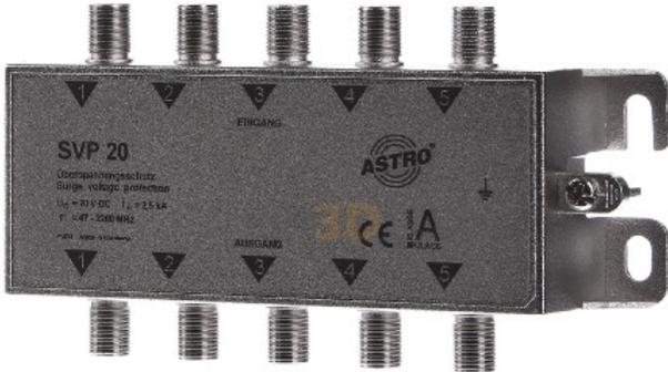
Überspannungsschutz SVP 20 Frequenz 47 ... 2200MHz, Überspannungsschutz 5-fach, zum Schutz von Endgeräten vor Beschädigungen durch Überspannung, 5 - 2200 MHz, Durchgangsdämpfung ca. 1 dB, Ein- und Ausgänge F-Buchsen
