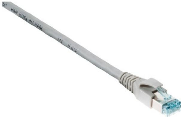
Patchk. 6AEA-RJ45SL GR-RT/RT 7,0 LKD9AA239680000 Kategorie 6A (IEC), Länge 7m, Steckverbindertyp Anschluss 1 RJ45 8(8), Steckverbindertyp Anschluss 2 RJ45 8(8), Mantel-Farbe grau, Farbe der Knickschutztülle rot, Pinbelegung 1:1
