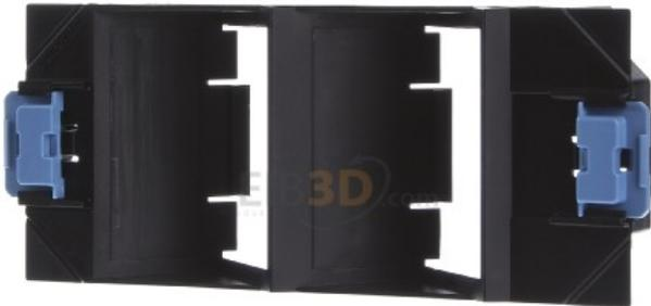
Geräteträger zweifach GTVD200 Anzahl der Leitungseinführungen 8, Länge 171mm, Breite 75mm, Tiefe 46mm, Ausführung Trägerform, Montageart Installationsgerät rasten, Anzahl der Zugentlastungen 0, Werkstoff sonstige, Geräteträger für 2 Montageplatten Datentechnik zu VQ06/VR06/VR10(rechts u links). Geräteträger nach DIN EN 50085-2-2 für Versorgungseinheiten zur Aufnahme von Montageplatten der Daten- und Medientechnik, doppelte Verriegelung der Rastschieber.
