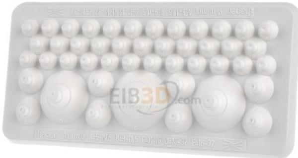
Leitungseinführung f.plom.Ber.,IP44/54 FZ426 Ausführung blind, Breite 220mm, Höhe 15mm, Tiefe 104mm, Werkstoff Kunststoff, Oberfläche unbehandelt, Vorprägungen, Leitungseinführung, univers, für nicht plombierten Bereich, zum Durchstecken. Leitungseinführung oben und unten für nicht plombierten Bereich zum Schrankeinbau.
