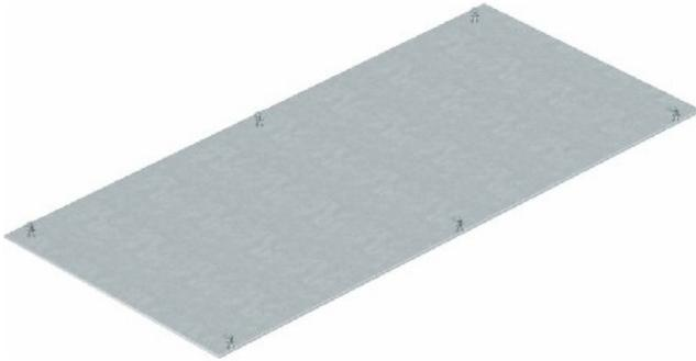
Montagedeckel blind 800x500x4, St, FS OKA D 500 Breite 500mm, Länge 800mm, Montageöffnung ohne, Anzahl der Montageöffnungen 0, Werkstoff Stahl, Oberfläche verzinkt, Zum Blindverschluss einer Kanaleinheit. Lieferung einschließlich Deckelbefestigungsschrauben.
