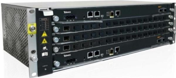
Optical Line Terminal Fibredata OLT3072 Das OLT3072 ist die Lösung um mehrere Dienste in mittelgroßen Netzen bis zu 3072 Teilnehmern zu übertragen und unterstützt GPON und Ethernet. Die Reichweite beträgt bis zu 60km mit einer Bandbreite von 2,5Gbps Downstream und 1,24Gbps Upstream an jedem GPON Ausgang. Das Gerät verfügt über Gigabit Ethernet Anschlüsse für Uplink 2x10Gbe, sowie einen Test-Ausgang. Eine Fernwartung ist möglich.
