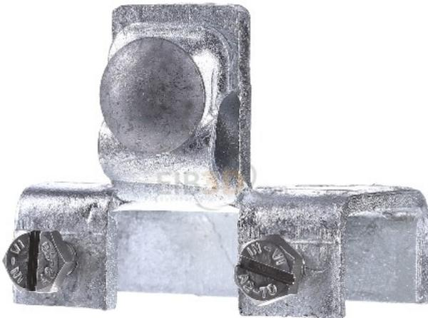
Anschlussklemme St/tZn senk. f.Profil.18-35 372 140 Art des Verbinders Anschlussklemme, Geeignet für Rundleiterdurchmesser 6 ... 10mm, Klemmbereich 18 ... 35mm, Werkstoff Stahl, Oberfläche tauchfeuerverzinkt, Art der Befestigungsschrauben Sechskantschraube, Anschlussklemme für Stahlträger nach DIN EN 62561-1, für den Anschluss an Stahlkonstruktionen. Ausführung senkrecht mit Klemmbock, Anschluss längs oder quer.
