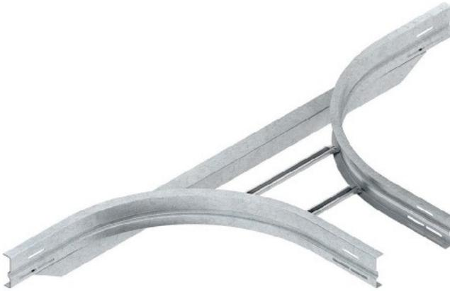
Anbau T-Stück WSTAR 105.200 F Ausführung des Seitenholms Profil (offen), Ausführung der Sprosse Profil ungelocht, Kabelleiter-Abgangsbreite 205mm, Kabelleiterhöhe 105mm, Innenradius 500mm, Ausführung integrierter Verbinder, Weitspann-Ausführung, Werkstoff Stahl, Werkstoffgüte sonstige, Oberfläche tauchfeuerverzinkt, Farbe ohne, Formstabil durch ein rückwärtig angebrachtes Stützprofil, sowie durch eingenetete, nach oben offene C-Profilsprossen mit 16 mm Schlitzweite
