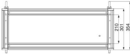
**Sammelschienenraum SF IP60 oben, 300x1200x800mm
