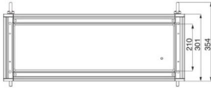
**Sammelschienenraum SF IP61 oben, 300x300x500mm NSYTBC335**
