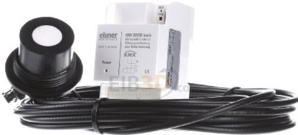
KNX SO250 Tanksonden Zur Erfassung der Füllmenge von Flüssigkeiten in Tanks und zur Distanzmessung. Konfiguration per ETS-Software. Auswertegeräte für Reiheneinbau. Ultraschall-Sonde inkl. 10 m Kabel. Lieferung mit Installationsanleitung. KNX SO250 basic: ohne Display, ohne Tasten. Betriebsspannung: Busspannung. KNX SO250: mit Display/Tasten. 2 zusätzl. Ausgangs-Relais. Betriebsspannung 230 V AC. Hersteller: Elsner Elektronik GmbH Art.-Nr.: ELS 70153 KNX SO250 basic
