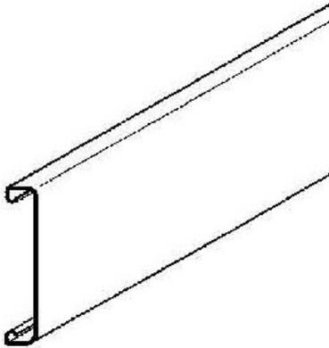
LFK-Deckel LD 60 Breite 60mm, Länge 2000mm, Werkstoff Stahl, Werkstoffgüte sonstige, Halogenfrei, Oberfläche bandverzinkt, Farbe natur, Leitungsschutzkanal Deckel, für den zusätzlichen Bedarf, der Potentialausgleich erfolgt zwangsläufig beim Aufrasten auf das Kanalunterteil. VDE zertifiziert! für Leitungsschutzkanäle: LLK... / LUK... für Industriekanäle: LUE... / LI... Abmessung (ca. Maß) B: 60 mm Lieferlänge L: 2000 mm Werkstoff: Stahl, bandverzinkt nach DIN EN 10346
