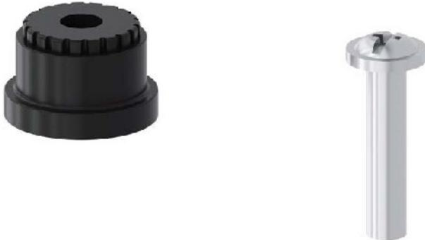
Adapter und Schraube 3SX5100-3B Adapter+Schraube für Ausgleich Einbautiefe bei Metallschaltern für Schwenkhebel längenverstellbar und Stangenhebel 3SE51 falls beim Umstellen von 3SE21 (3SE21.0.-UW/VW/WW/U/V/W) auf 3SE51 notwendig ist Safety is a SIRIUS business.
