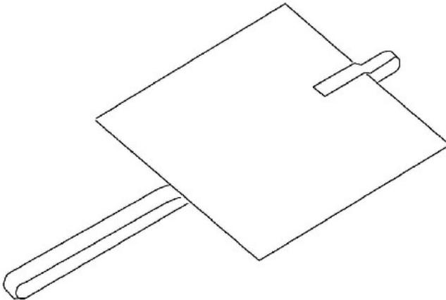
Plattenerder 2m lang 328F2 Länge 1000mm, Breite 500mm, Stärke 3mm, Anschlussfahne Länge 2000mm, Werkstoff Stahl, Oberfläche tauchfeuerverzinkt, Plattenerder nach DIN EN 62561 (VDE 0185-561), Plattenprofil mit angeschweißter Bandeisenfahne. Abmessungen (ca. Maße) Plattenprofil L x B x t : 1000 x 500 x 3 mm Abmessungen (ca. Maße) Bandeisenfahne B x t : 30 x 3,5 mm Länge Bandeisenfahne (ca. Maß) : 2000 mm Werkstoff : Stahl, feuerverz.
