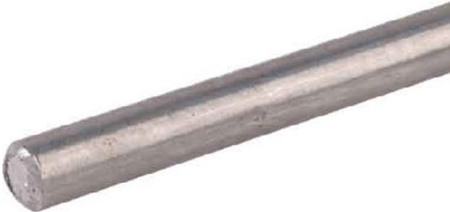
Runddraht AlMgSi halbhart 8mm 840 008 Leiter-Durchmesser 8mm, Leiterquerschnitt 50mm<sup>2</sup>, Leiter-Klasse Kl.1 = eindrätig, Anzahl der Einzeldrähte 1, Leiter-Material Aluminium, Werkstoffgüte Leiter-Material Aluminium-Magnesium-Silizium-Legierung, Eigenschaft Leiter-Material halbhart, Oberfläche unbehandelt, Alu-Draht nach DIN EN 62561-2, für den Einsatz bei Blitzschutzanlagen als Fangeinrichtung, Ableitung oder Potentialausgleich. Ausführung halbhart.
