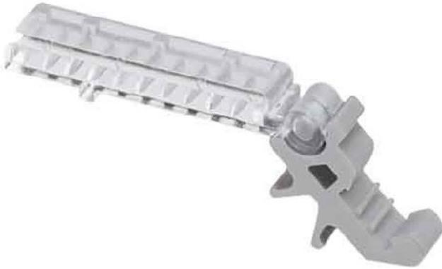
Bezeichnungsschild AK-DST/UK Aufdruck ohne, Rastermaß 5mm, Farbe sonstige, Bezeichnungsschild, zur Gruppenkennzeichnung von Klemmen deren oberste Schildchennut 45° abgewinkelt ist, z. B. UK-Klemmen, einrastbar in Schildchennut, die Schildchenaufnahme ist um 120° schwenkbar und wird mit EST 24 x 4 oder ESL 24 x 4 beschriftet
