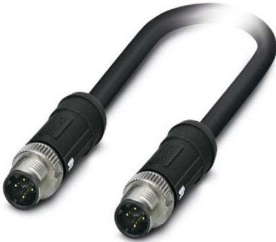
Netzwerkkabel NBC-MSD/ 5,01407343 Mantel-Farbe sonstige, Zul. Kabelaußentemperatur nach Montage ohne Erschütterung -40 ... -40°C, Kategorie sonstige, Netzwerkkabel, PROFINET CAT5 (100 MBit/s), Ethernet CAT5 (100 MBit/s), 4-polig, PE-X, schwarz RAL 9005, geschirmt, Stecker gerade M12 SPEEDCON / IP65, Kodierung: D, auf Stecker gerade M12 SPEEDCON / IP65, Kodierung: D, Kabellänge: 5 m, für Bahnanwendungen
