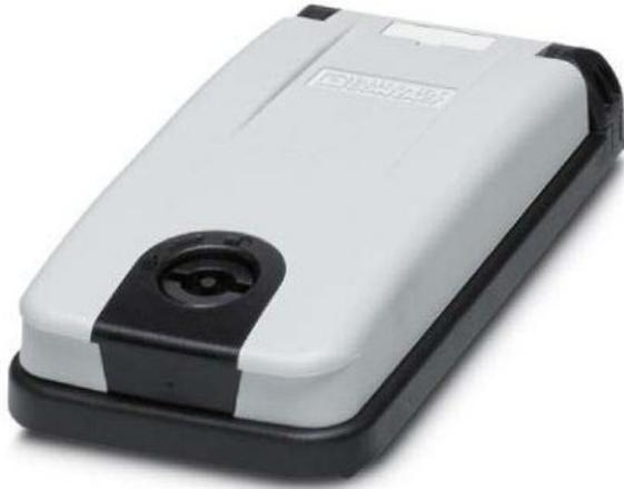
Einbaurahmen SI-M1A-GL Werkstoff Kunststoff, Oberfläche sonstige, Schutzart (IP) IP65, Breite 66mm, Tiefe 34,5mm, Einbaurahmen für eine Frontplatte/Steckdose, Rahmen: schwarz, Deckel: grau, Schließung mit 3 mm Doppelbart und beige packtem Drehknopf.
