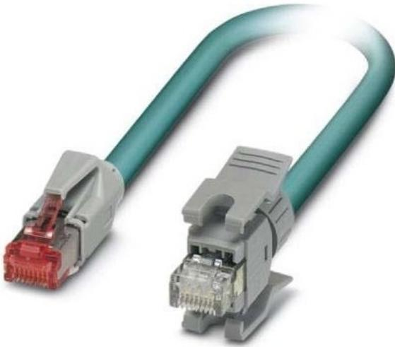
Netzwerk-kabel VS-IP20-IP201423071 Kabeltyp SF/UTP, Kategorie sonstige, Länge 1m, Steckverbindertyp Anschluss 1 RJ45 8(4), Steckverbindertyp Anschluss 2 RJ45 8(4), Mantel-Farbe sonstige, Knickschutzdüse aufgesteckt, Rasthebelschutz, Kabelkonstruktion sonstige, Pinbelegung 1:1, Konfektioniertes Ethernet-Kabel, geschirmt, 4-paarig, AWG 26 flexibel (7-drähtig), RAL 5021 (wasserblau), RJ45-Stecker/IP20 auf RJ45-Stecker/IP20 gedreht, Line, Länge 1 m
