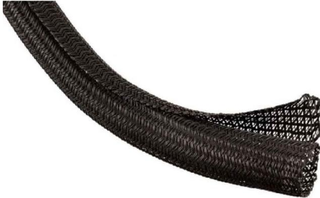
Automatic Wrap sw 3,0m 2,54cm 930.902 Max. Bündeldurchmesser 25,4mm, Werkstoff Kunststoff, Oberfläche unbehandelt, Halogenfrei, Farbe schwarz, Lösbarer Verschluss, Brennbarkeitsklasse des Isolierstoffs nach UL 94 sonstige, 25 % Überlappung für sichere Kabelbündelung, Widersteht Chemikalien und Lösungsmitteln, Halogenfrei, Schnitt- und abriebsresistent, Formstabil bei einer Betriebstemperatur von -75 °C bis +125 °C
