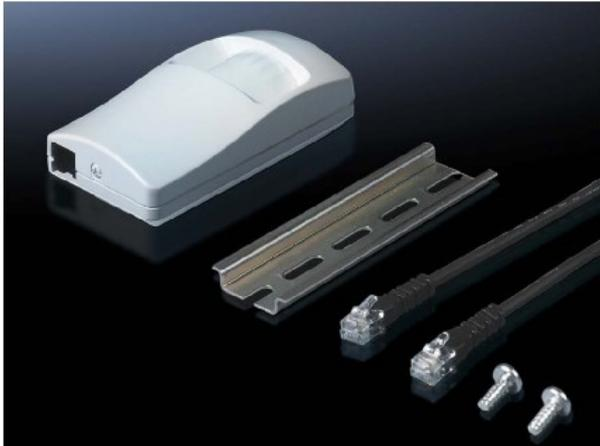
Überwachungssystem CMC III Leckagesensor DK 7030.440 Ausführung sonstige, DK CMC III Leakage-Sensor, 15 m, Messmethode: Leitfähigkeitsüberwachung, Bestehend aus:., Kompaktes Kunststoffgehäuse, Externes Sensorkabel, 15 m
