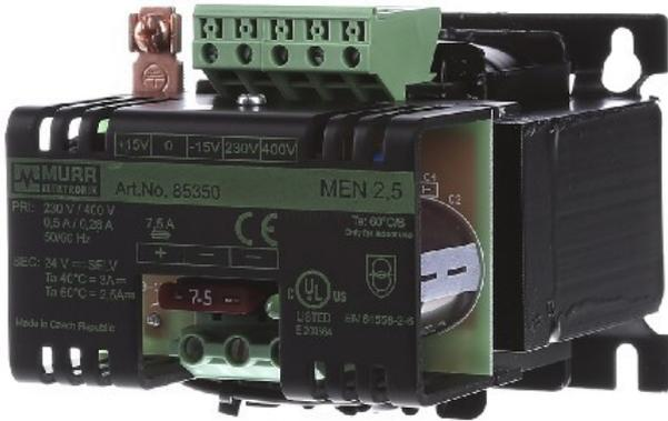
Kompaktnetzgerät 85350 Spannungsart der Versorgungsspannung AC, 1. Ausgangsspannung 24 ... 24V, Max. Ausgangsstrom 1 2,5A, Bemessungsversorgungsspannung bei AC 50 Hz 230 ... 400V, Leistungsabgabe 60W, Stabilisiert, Ausführung des elektrischen Anschlusses Schraubanschluss, Wandmontage möglich, Breite 84mm, Höhe 83mm, Tiefe 124mm, Schutzart (IP) IP20, Effektive Restwelligkeit < 5%, Schlüssellochbefestigung, Eingangsspannung umklemmbar +/- 15V, Zulassungen: UL, cUL, CE
