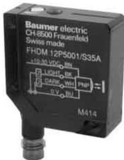
Lichttaster FHDM 12P5001/S35A Tastweite 300 ... 300mm, Max. Schaltabstand 300mm, Max. Ausgangsstrom 100mA, Breite des Sensors 12,4mm, Höhe des Sensors 48mm, Länge des Sensors 35mm
