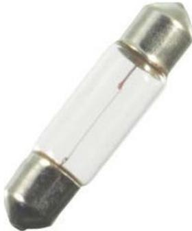
Lampenleistung 3 W, Lampenspannung 15 V, Lichtstrom 6 lm, Sockel S7, Technologie Glühlampe, Lampenform sonstige, Halogen nein, Krypton nein, Xenon nein, Farbe farblos, Farbtemperatur 2700 K, Durchmesser 8 mm, Gesamtlänge 31 mm, Geeignet für Taschenleuchten nein, Geeignet für Anzeigezwecke ja, Geeignet für Rundumleuchte nein, Nennstrom 200 mA, Mittlere Nennlebensdauer 2000 h
