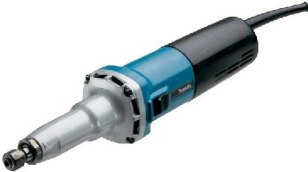
Geradschleifer GD0800C Nennleistungsaufnahme 750W, Spannung 230V, Frequenz 50 ... 60Hz, Werkzeugaufnahme Spannzange, Leerlaufdrehzahl 7000 ... 280001/min, Länge 371mm, Breite 75mm, Höhe 75mm, Gewicht 1,88kg, Für Polierschleifstifte bis 25 mm Durchmesser. Spindelgehäuse aus Aluminium-Druckguß mit nur 35 mm Durchmesser. Spannhals mit 43mm Durchmesser. Labyrinthdichtung schützt Lager und Getriebe gegen Staub und Schmutz. Mit Anlaufstrombegrenzung.
