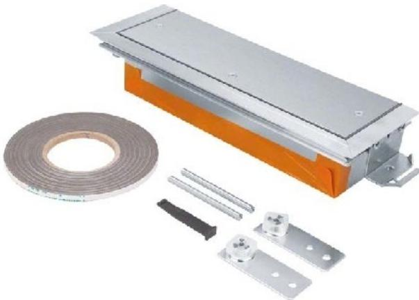
Endstück mit Wanne BKWDE300070 Breite 300mm, Höhe 70mm, Geeignet für estrichbündigen offenen Unterflurkanal, Geeignet für estrichbündigen geschlossenen Unterflurkanal, Nivellierbereich 70 ... 110mm, Endstück höhenverstellbar mit Wanne/Dichtmöglichkeit Stahl BKWD 300x(70-110)mm. Endstück für estrichbündigen Installationskanal nach DIN EN 50085-1 und DIN EN 50085-2-2, mit Bodenwanne, als Systemzubehör.
