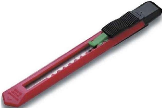
Universalmesser 135mm 12 0080 Länge der Klinge 28mm, Gesamtlänge 135mm, Klingenform gerade, Cuttermesser, Mit Schutzabdeckung, Ausziehbar, Mit Verriegelung, Universalmesser leichte Ausführung aus Kunststoff, mit verstellbarem versenkbarem Messer (Abbrechklingen, 9 mm) Economy Größe 135 mm
