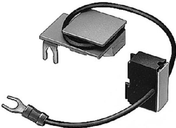
Überspannungsbegrenzer RC-Glied 3TX7522-3U, Funktion=RC-Glied, Bemessungssteuerspeisespannung Us bei AC 50 Hz=240..400 V, Bemessungssteuerspeisespannung Us bei AC 60 Hz=240..400 V, Bemessungssteuerspeisespannung Us bei DC=0 V, Spannungsart zur Betätigung=AC, Überspannungsbegrenzer RC-Glied zum Aufschnappen AC 240-400 V für Schütze Baugröße 8...12
