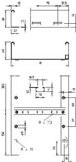
**Kabelleiter gelocht mit VS Sp.60x200x3000 LG 620 VS 3 FS**
