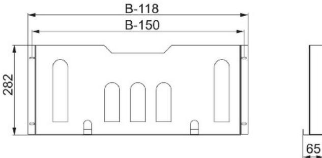
Plantasche Metal für Tür 800 NSYSDP8M Ausführung Schaltplantasche, Werkstoff Metall, Geeignet für Gehäusebaubreite 800mm, Farbe grau, RAL-Nummer 7035, Höhe 282mm, Tiefe 65mm, Spacial Metall-Dokumenten-Tasche. Breite 800 mm. Zur direkten Montage am Türrahmen. Höhenverstellung alle 25 mm am Türverrahmen. Stahl, lackiert. Grau RAL 7035.
