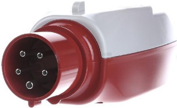
Motorschutzstecker 16A, 5pol. 6,3-9,0A 50 304230 Ausführung des Motorschutzes thermischer Auslöser, Ausführung des Betätigungselements Drehknebel, Einstellbarer Strombereich 6,3 ... 9A, Farbe des Steckvorsatzes rot, Gehäusefarbe grau, Bemessungsspannung 400V, Bemessungsdauerstrom Iu 16A, Mit angespritztem CEE-Stecker, 3P+E+N, 6h, 50-60 Hz
