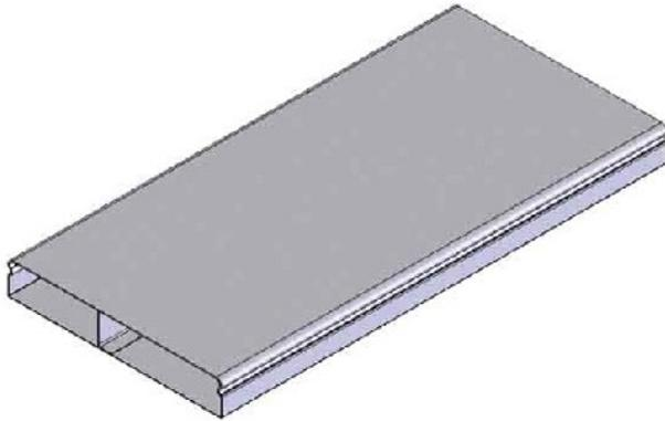
U-Kanal 2-züge Stahlblech verz. 2m UK240482, Breite=240 mm, Höhe=48 mm, Anzahl der Züge=2, Länge=2000 mm, Einsatzbereich=estrichüberdeckt, Oberteil abnehmbar=ja, Werkstoff=Stahl, Oberfläche=verzinkt, Unterflurkanal 2-zügig estrichüberdeckt aus Stahlblech UK 240x48mm. Unterflur-Installationskanal nach DIN EN 50085-1 und DIN EN 50085-2-2 für estrichüberdeckte Montage mit Trennsteg, abnehmbares, mit Trennstegmarkierungen versehenes, Oberteil zum einfachen Einlegen von Leitungen.
