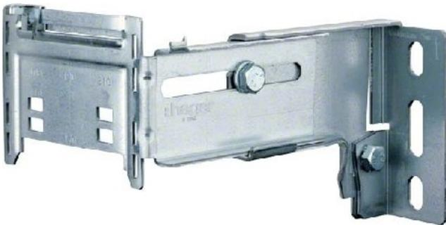
Universalkonsole Abstand 120-200,verz G 2262 Ausführung Wandmontage, Wandabstand 120 ... 200mm, Geeignet für Kanalbreite 0mm, Kanalmontage einhängen, Konsole zur Verwendung mit Adapterplatte für Wandabstand 120-200mm aus Stahl. Universalkonsole, Neigungswinkel vertikal verstellbar +/- 3°, verstellbarem Wandabstand, in Verbindung mit der Adapterplatte, zur werkzeuglosen Befestigung des Brüstungskanal. Hinweis: Zur Konsolenmontage werden Universalkonsole und Adapterplatte benötigt.
