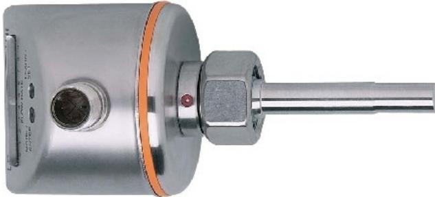
Strömungswächter SI5000 Strömungssensoren, Strömungswächter, Kompaktbauform für Adapter, Prozessanschluss: Innengewinde M18 x 1,5 für Adapter, 3-Leiter, DC PNP, Betriebsspannung: 19...36 V DC, Stromaufnahme: 60 mA, Schließer / Öffner programmierbar, n.o. / n.c. progr., Steckverbindung, M12-Steckverbindung, Werkstoff Gehäuse: V4A / 316L / 1.4404 V2A / 301 / 1.4310 PC (Polycarbonat) PBT-GF 20 EPDM/X, Sensorwerkstoff: V4A / 316L / 1.4404 O-Ring: FKM 8x1,5 gr 80° Shore A
