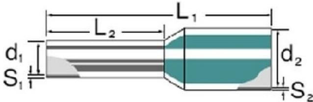
Aderendhülse H1,0/12D R Bauform Standard, Nennquerschnitt 1mm<sup>2</sup>, Hülsenlänge 12mm, Isoliert, Werkstoff der Isolation sonstige, Farbe rot, Werkstoff Kupfer, Oberfläche verzinkt, Durch den Einsatz der Aderendhülse werden die einzelnen Litzen eines abisolierten, flexiblen Leiters durch ein galvanisch verzinktes Kupferröhrchen sicher vercrimpt. Mit der Verwendung der Aderendhülse wird eine langfristig gleichbleibende Qualität bei elektrischen Verbindungen geschaffen.
