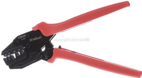
Presswerkzeug AE 10-50 10 4200 Geeignet für Aderendhülsen, Pressform Trapezpressung, Querschnitt 10 ... 50mm<sup>2</sup>, Länge 390mm, Mit Sperrvorrichtung (bei mechanischen Werkzeugen), Ausführung/Betätigung mechanisch, Anzahl der mitgelieferten Einsätze 0, Automatische Presswerkzeuge für Aderendhülsen Trapezverpressung 10 qmm - 50 qmm
