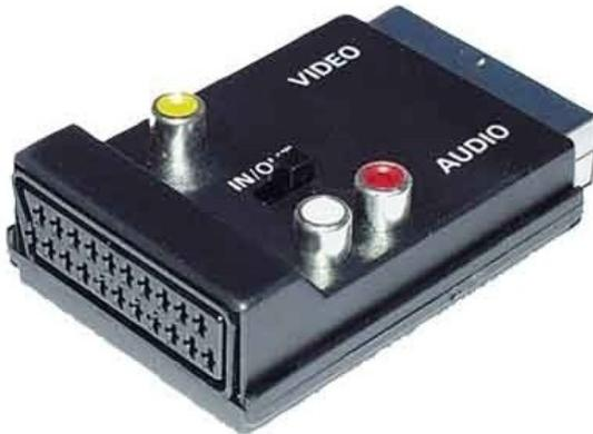
Scart-Adapter VC916, Anschluss 1=Scart, Ausführung Anschluss 1=sonstige, Anschluss 2=Cinch, Ausführung Anschluss 2=Buchse, Geschirmt=ja, Video-Überspiel-Adapter, für Aufnahme oder Wiedergabe, zum Anschluss eines Zusatzgerätes, mechanische Umschaltung, der Adapter enthält alle Verbindungen nach EN 50 049, 21pol. Scart-Stecker/-Kupplung + 3x Cinchkupplung (Audio/Video), SB-Verpackung
