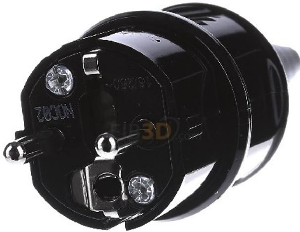
**Schutzkontaktstecker mit doppeltem Schutzleiter und Kabelknickschutz bis 3x2,5 qmm, 16A, 230V AC,...**
