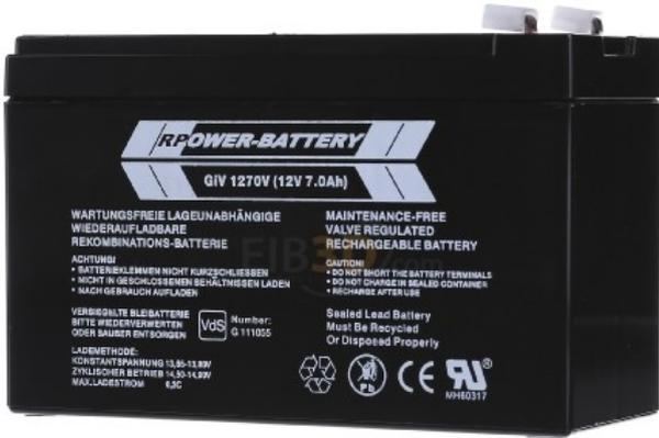
Akku 12V/7Ah SAK 7 Größenbezeichnung Block, Anzahl der Zellen 6, Ausführung sonstige, Nennspannung 12V, Kapazität 7000mAh, IEC-Bezeichnung sonstige, Sonstige Bezeichnung sonstige, Länge 151mm, Höhe inkl. Pole 94mm, Breite 65mm, Durchmesser 0mm, Kunststoffgehäuse, Umgebungstemperatur -20 ... 50°C, Gewicht 2600g, Blei-Gel Akkumulator 12V / 7 Ah Wartungsfrei durch geschlossene Bauweise nach EN 50014/VDE 0170/0171 Teil 1/5.78
