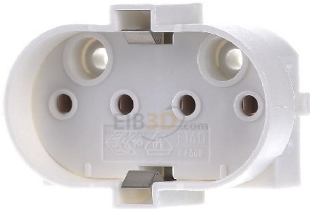
Fassung 2G11 ws,Bohrung M3 101489 Ausführung Aufbaufassung, Werkstoff Kunststoff, Farbe weiß, Fassung 2G11, Befestigungsart Schraubbefestigung, Nippelgewinde ohne, Gehäuse PBT GF, T140, Nennwert 2/500, Doppel-Steckklemmen 0,5-1 mm<sup>2</sup> (Lampenkreis), Einzel-Steckklemmen 0,5-1 mm<sup>2</sup> (Starterkreis), Drehzapfen für Winkel 105824, rückseitige Bohrungen für selbstschneidende Schrauben nach ISO 1481/7049-ST4,2-C/F, vorderseitige Durchgangslöcher für Schrauben M3
