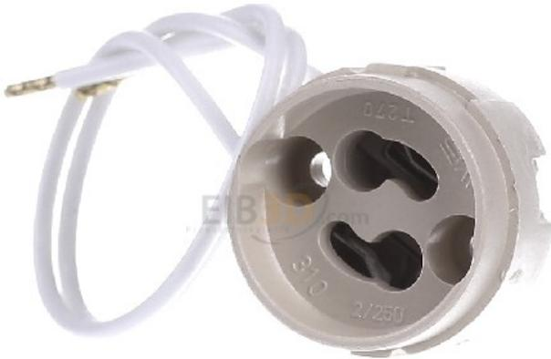
Fassung weiß PTFE Leitung 504305 Ausführung Steckfassung, Werkstoff Kunststoff, Farbe weiß, Fassung GU10, Befestigungsart Schraubbefestigung, Nippelgewinde ohne, GU10 GZ10-Fassung für Leuchten der Schutzklasse II, Gehäuse LCP natur, T270, Nennwert 2/250, Leitungen Cu vernickelt, mehrdrähtig 0,75 mm<sup>2</sup>, doppelte PTFE-Isolation, Länge 150 mm, Durchgangslöcher für Schrauben M3
